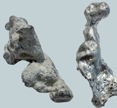
So sieht das aus der Schlacke gewonnene Aluminium aus, nass (l) trocken (r).
