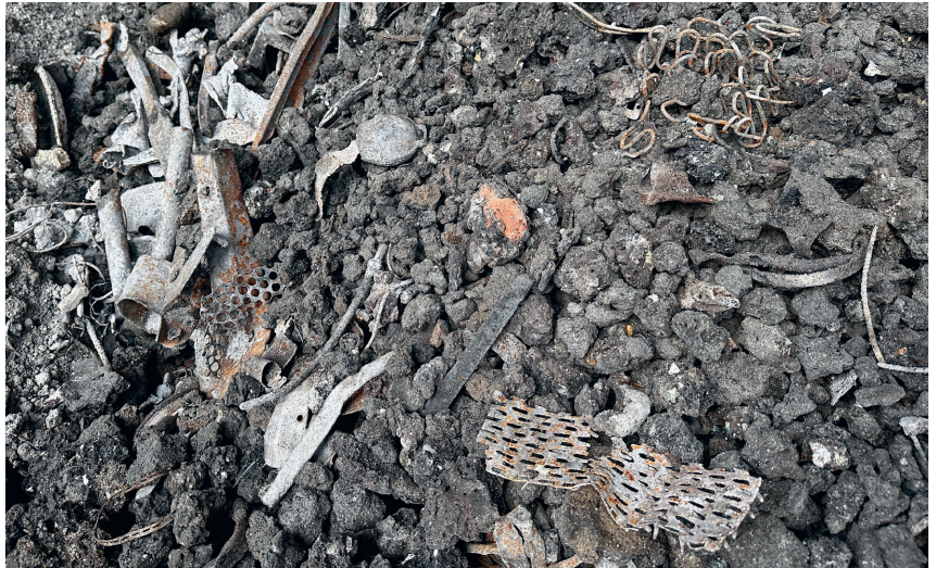
Nasse Schlacke mit Metallresten, wie sie heute entsteht.
